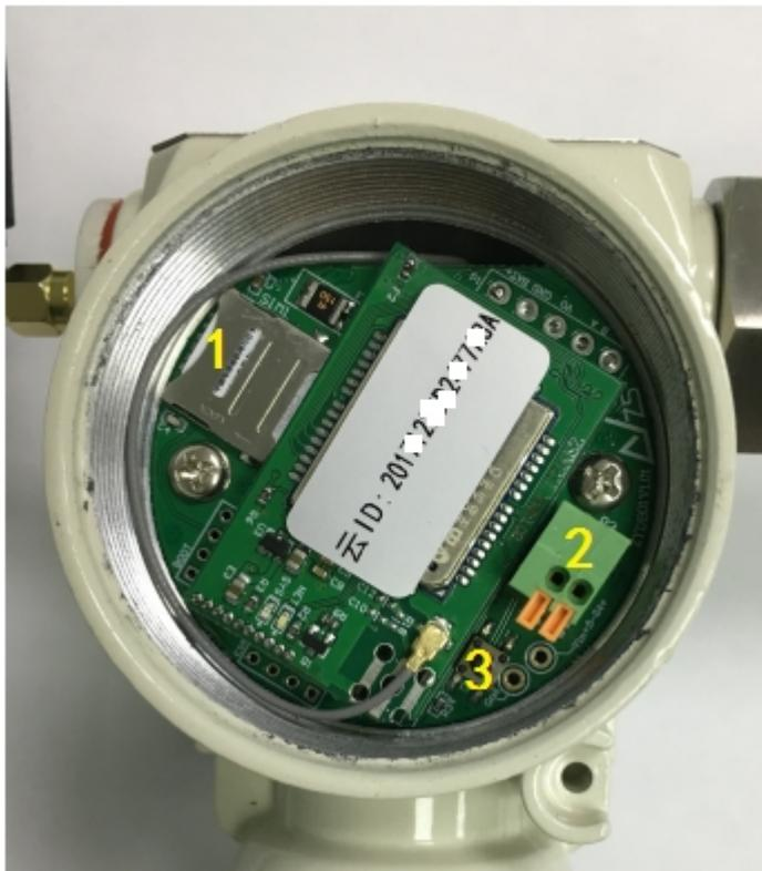
1 号位置为 SIM 卡的插装位，在此处装入中国电信或中国移动 NB 卡，首先拨开 SIM 卡座上盖，然后将 SIM 卡（中号卡）放入到卡座（对着 SIM 卡座的缺口，芯片面朝下），放好后将 SIM 卡座的上盖回锁
