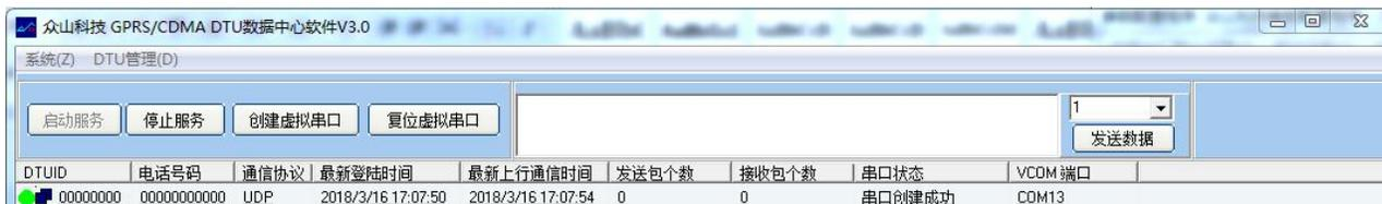
待DTU登录到数据中心后，点击设置程序界面“透明传输测试”进入透明模式界面：
