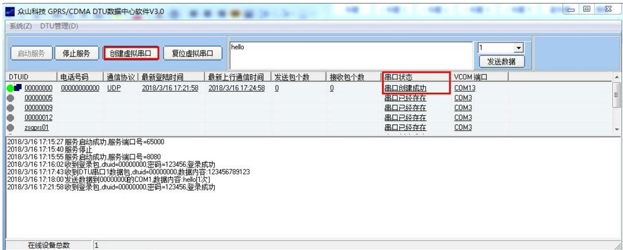
首先设备连接上 WiFi 且云开关开启再点击 创建虚拟串口按钮, 这时会发现在线设备 00000000 串口状态为串口创建成功。然后打开参数配置软件 端口号选择 创建的虚拟串口号! 配置方法与本地参数配置相同。 如图:
