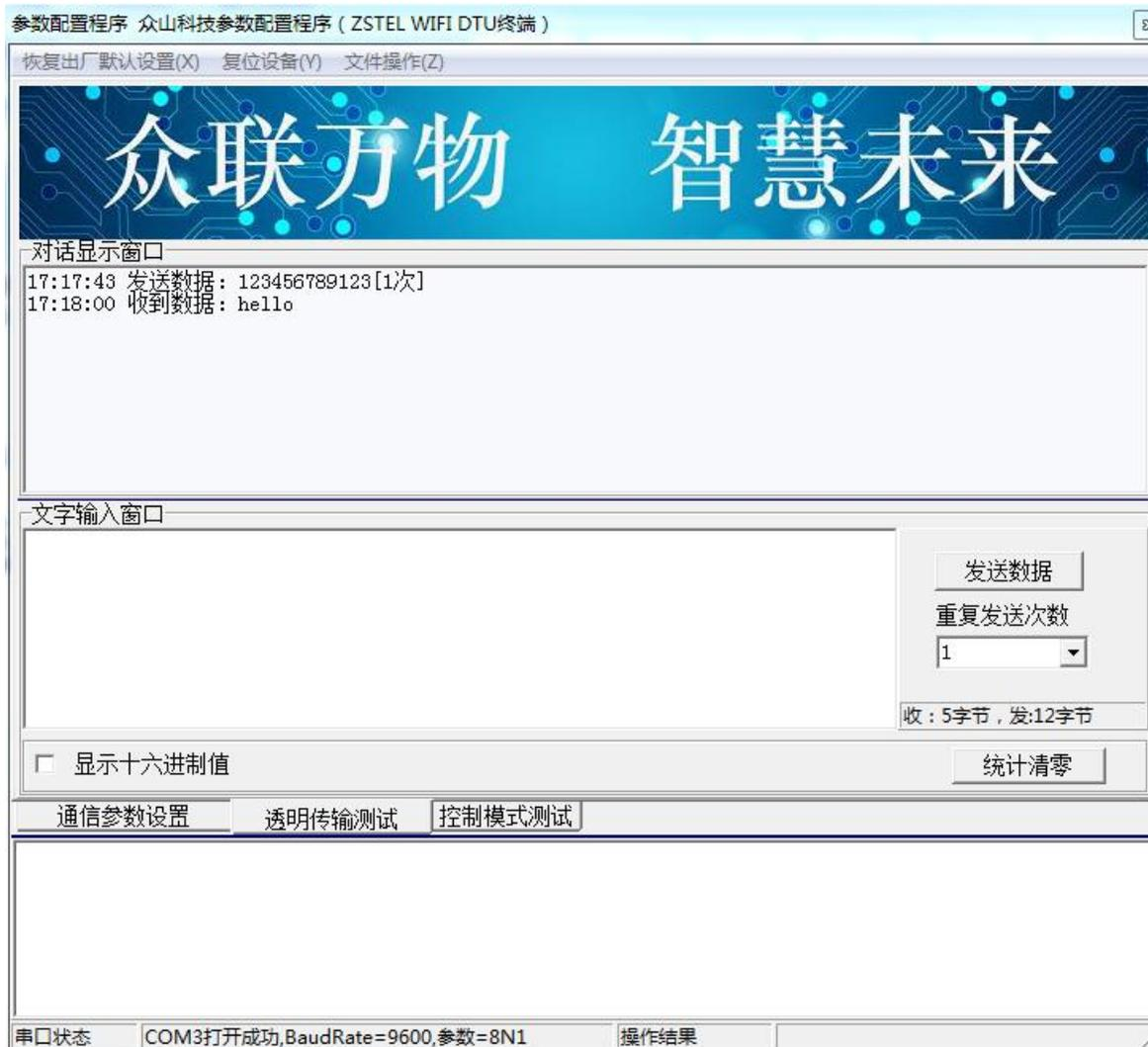
正常情况下，几秒之内DTU就能接收到数据中心下发的数据，用户可以在设置程序对话显示框中查
