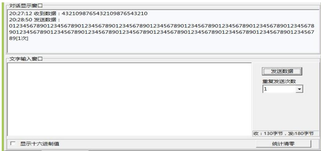
在数据采集中心和DTU设置程序中均提供了收发字节总数的统计显示，通过对比统计结果，可以知道数据采集中心和DTU之间的通信是否完全正确。
