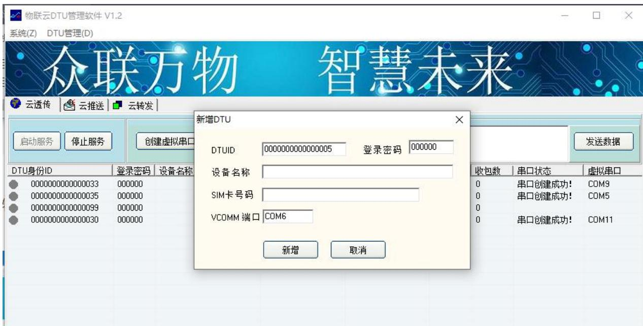
3.1.5 选中当前的DTUID ,点击软件窗口的“创建虚拟串口”，串口状态 栏会提示串口创建成功！
