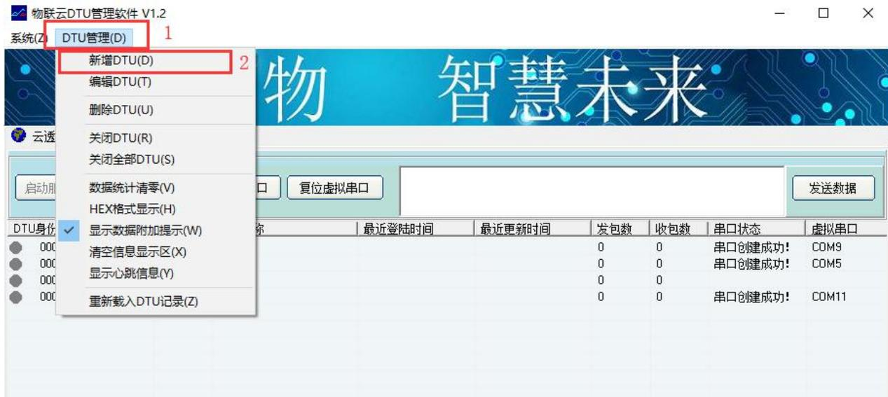
3.1.4 在弹出的对话框中，DTUID栏输入 DTU设备标签上的16位云ID，登陆密码输入000000（DTU出厂默认），设备名称栏选填，SIM 卡号栏选填，VCOMM栏填入想要虚拟出的串口号，填入前最好查看下 当前电脑是否已经有了的此串口号，不能重复创建
