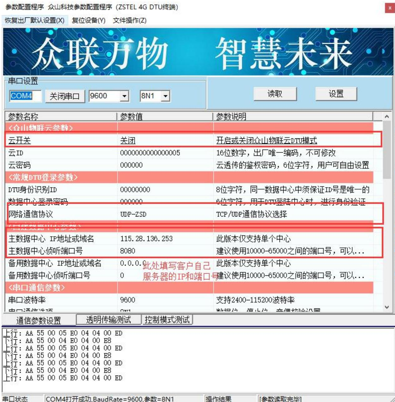
7.2的测试过程与7.1大致相同，区别仅在于DTU的参数“网络通信协议”应设置为ZSD-TCP,数据接收软件需要用我公司提供的数据中心软件，更多细节详见标准版说明书-数据收发章节
